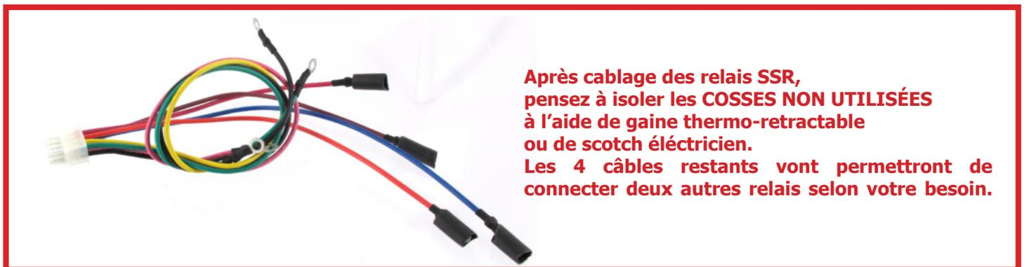
**Après câblage des relais SSR, pensez à isoler les COSSES NON UTILISÉES à l'aide de gaine thermo-retractable ou de scotch électrique. Les 4 câbles restants vont permettre de connecter deux autres relais selon votre besoin.**
