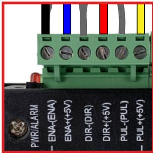
**2** Insérez ensuite les embouts des câbles des moteurs, en provenance de la machine :
