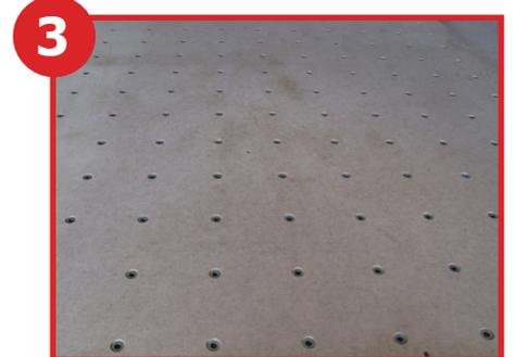
3 Prenez soin de visser dans l'axe des trous (bien verticalement) pour faciliter l'utilisation ultérieure des valets et presses qui maintiendront vos pièces en place sur la dalle durant les usinages
