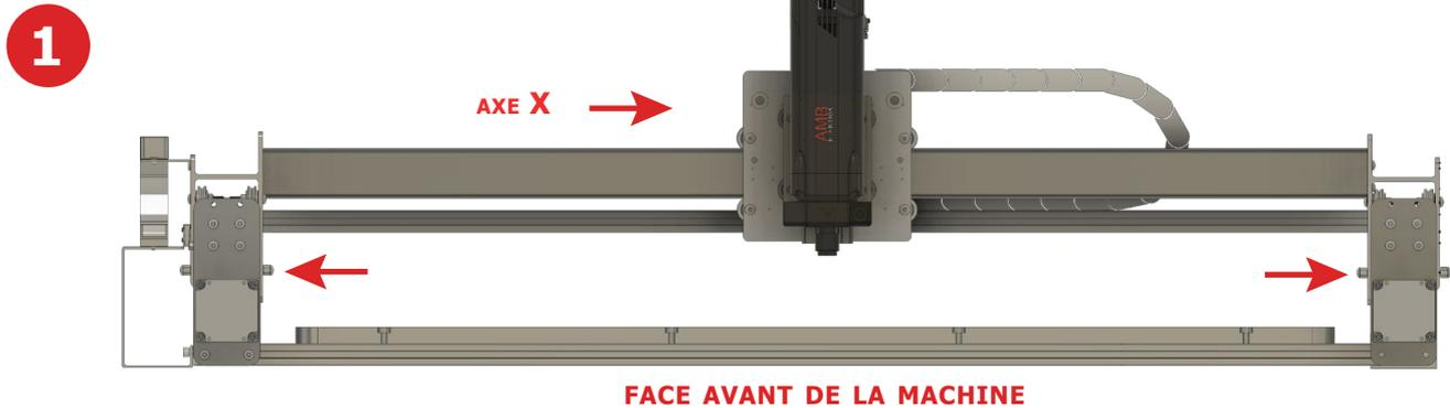
En premier lieu, **positionnez l'assemblage des portiques de façon à ce que l'axe X soit parallèle à la face avant de la machine et les portiques Y équidistants de la dalle.**
