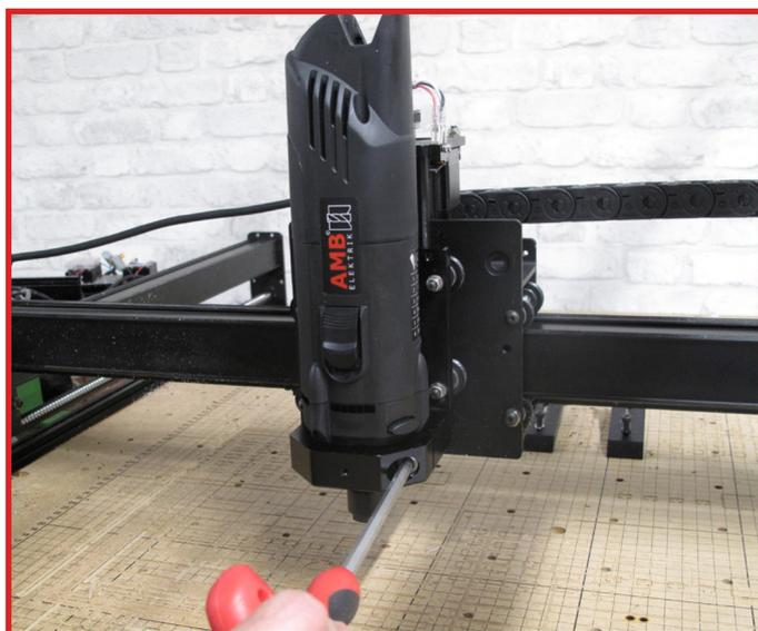
**1** Insérez la fraiseuse dans son support, bouton marche/arrêt face à vous jusqu'en butée.
