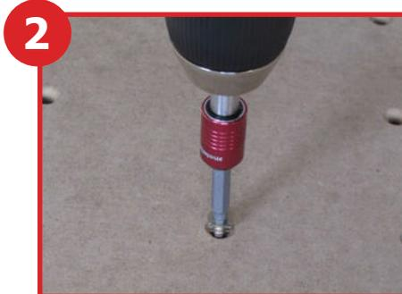
2 Idéalement, utilisez un embout « Allen » (6 pans) 5mm au bout d'une perceuse ou visseuse pour visser les inserts. Cela vous fera gagner un temps considérable par rapport à un vissage à la main avec une clé Allen
